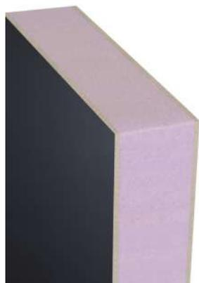
Les panneaux de portes Phare PVC, mixte et Aluminium sont équipés de série, de 2 parements et d'une structure mousse isolante haute densité de 30 kg/m<sup>3</sup>, résistance à la compression 300 kPa, pour une épaisseur totale de 31 mm.
