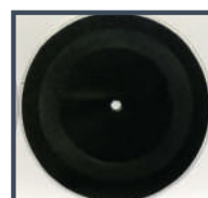
Un coloris plaxé standard noir après 100 cycles d'abrasion : une décoloration apparaît de façon précoce .
